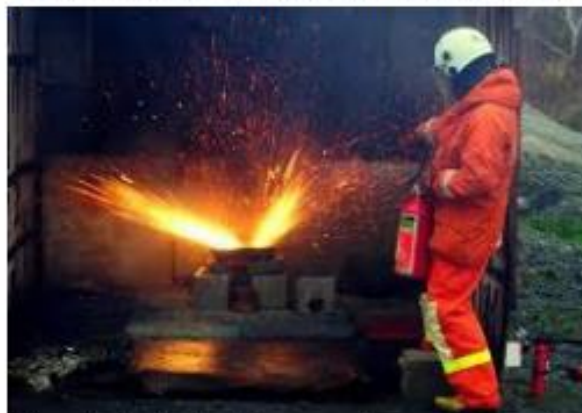
Många battericeller brinner explosionsartat med långa jetstrålar. Bilden visar brand i litiumceller.
